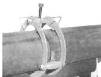
Центраторы предназначены для центровки торцов труб при монтаже перед сваркой диаметром от 37мм до 1420мм.
