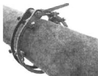
Центраторы наружные эксцентриковые ЦНЭ предназначены для центровки торцов труб для сварки. Путем применения проставок или перестановки осей каждый центратор используется для труб нескольких диаметров.
