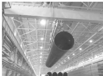
Траверса предназначена для перегрузки труб  $\varnothing 1420$ мм, длиной от 8000мм до 12500мм на трубных заводах в условиях ограничения по высоте, при помощи торцевых трубных захватов. Расстояние по точкам зацепа не более 1000мм.
